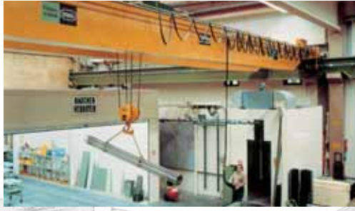
Система электропитания на мостовом кране: управление тележками с пульта.
