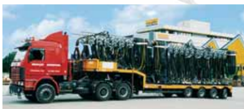
Предварительно смонтированное кабельное устройство с крупногабаритными тележками.
